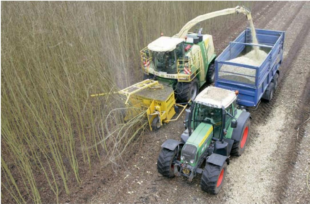
Abbildung 4-21: Erntevorgang bei einer Kurzumtriebsplantage. Quelle: FNR (Abrufbar unter: [http://www.fnr-server.de/ftp/pdf/literatur/pdf\\_292-brosch\\_energieholzproduktion\\_2009.pdf](http://www.fnr-server.de/ftp/pdf/literatur/pdf_292-brosch_energieholzproduktion_2009.pdf))
