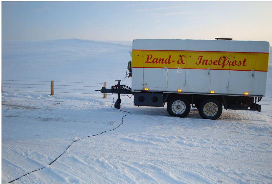
Abbildung 4-15: Kühlung des Kühlwagens mit Netzstrom
