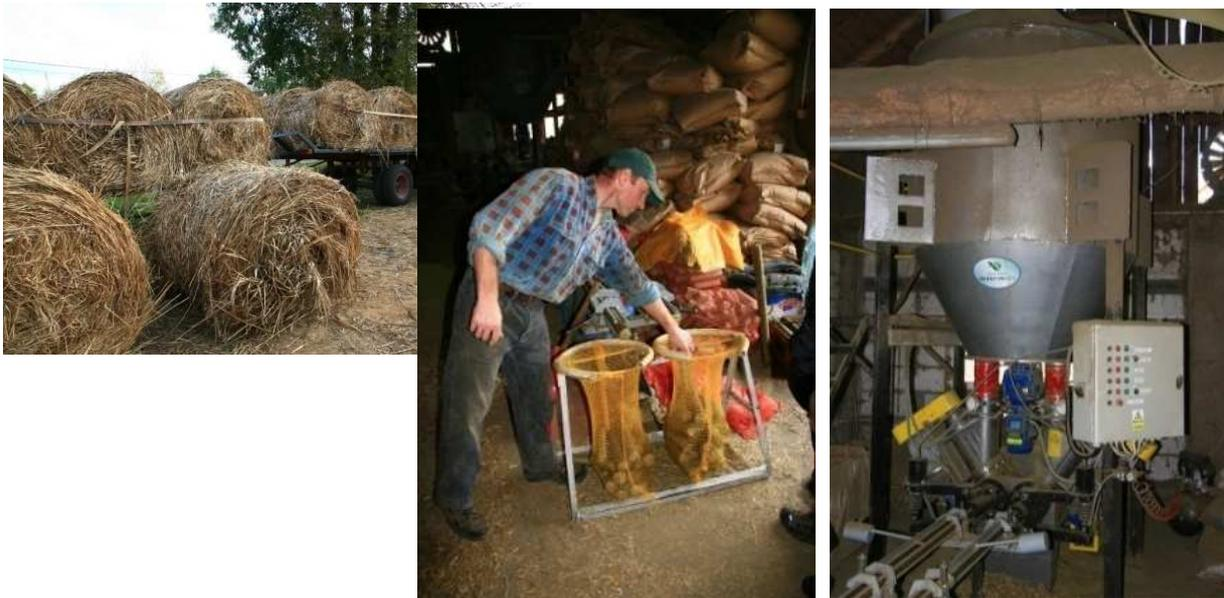
Abbildung 4-20: Bergung und Verarbeitung von Schilf zu Schilfbriketts. Quelle: EURONATUR.
