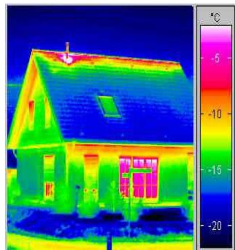
Abbildung 4-7: Schwachstellen werden sichtbar in der Thermographieaufnahme.
